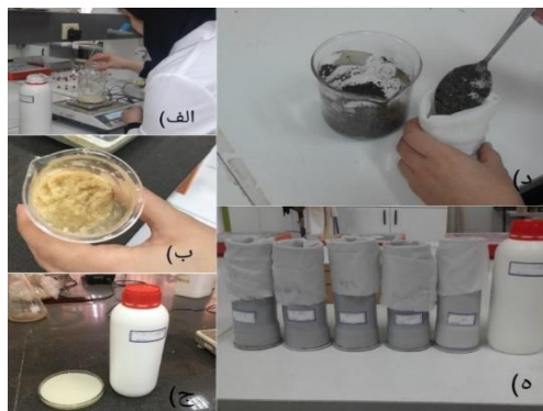
شکل ۲- مطالعات آزمایشگاهی: مراحل تهیه فیلترهای مورد استفاده در تحقیق: الف و ب) تهیه فیلتر میکرو خاک اره؛ ج) نانو مواد؛ د و ه) تهیه فیلترها Figure 2. Laboratory studies: stages of preparation of filters used in research: a and b) preparation of micro sawdust filter; C) nanomaterials; D and e) preparation of filters
