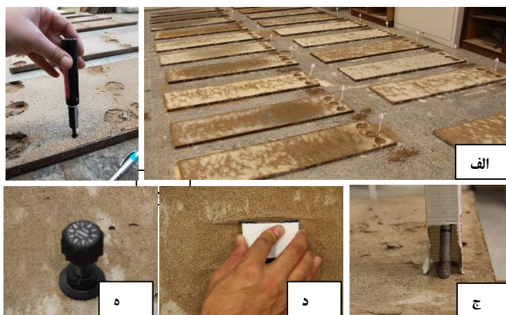
شکل ۱- اندازه‌گیری خصوصیات فیزیکی: الف) سینی‌های مالچ‌پاشی شده ب) دستگاه اندازه‌گیری فروسنج دستی، ج) میله فلزی، د) سمباده و ه) دستگاه پره برشی
