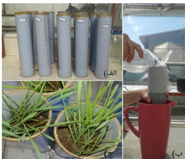
شکل ۱- مطالعات گلخانه‌ای: الف) تهیه گلدان از لوله‌های پلی‌اتیلنی؛ ب) عبور پساب از فیلترهای تولید شده؛ و ج) رشد و نمو گندم در گلدان‌ها Figure 1. Greenhouse studies: a) Preparation of pots from polyethylene pipes; B) the passage of wastewater through the produced filters; And c) the growth and development of wheat in pot
